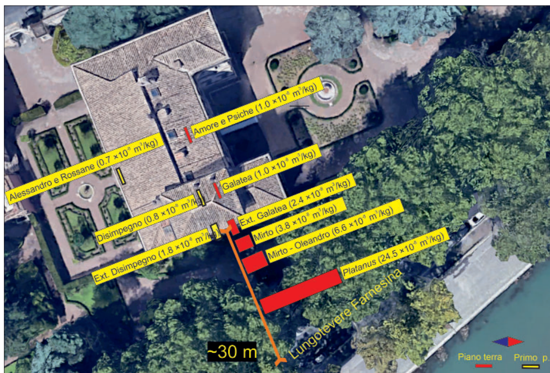
Figura 4 - Villa Farnesina: decremento dei valori di suscettività magnetica con l'aumento della distanza da Lungotevere Farnesina: le logge, collocate ad almeno 30 m di distanza dalla strada, risultano preservate da importanti accumuli di particolato metallico automobilistico (modificato da Google Maps e da Winkler et al., 2022).
