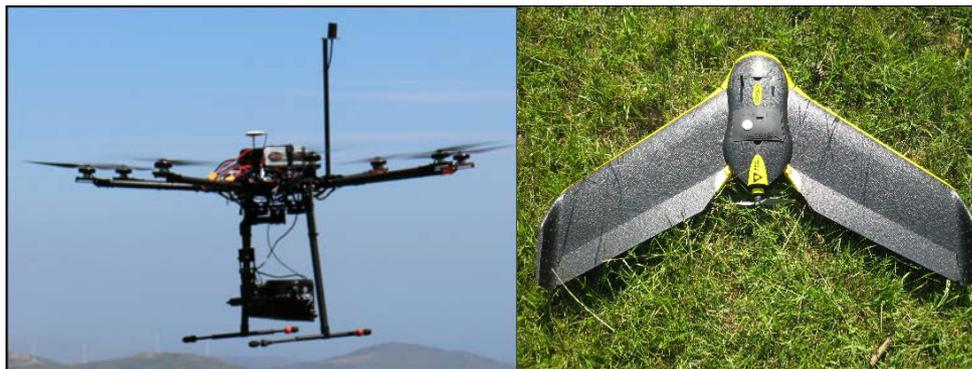
Figura 4 - Ottocottero con sensore LiDAR (sinistra) e drone ad ala fissa eBee (destra).
