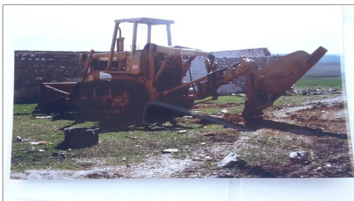
*Figura 6* - Trattore cingolato FIAT ALLIS da 150 CV accessoriato anteriormente con lama livellatrice-spietatrice e posteriormente con aratro SOGEMA dal vomere lungo circa 2 metri per una lavorazione profonda circa 80-100 cm.
