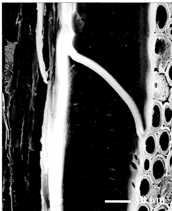
Foto 2 - Vaso con perforazione semplice nel legno indifferenziato. Foto al s.e.m. - 750 X
