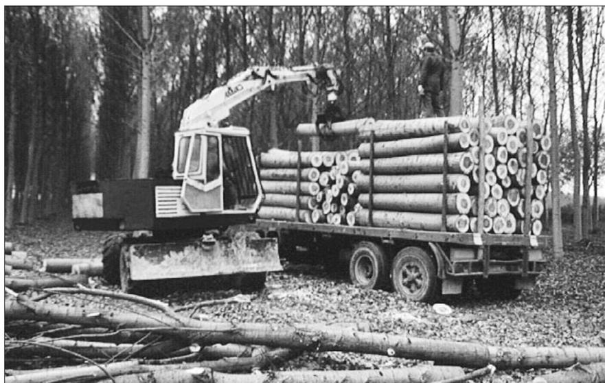
Figura 3 – Caricatore semovente impegnato nel carico di assortimenti da sfogliatura.
