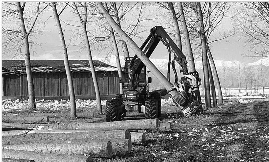
Figura 4 – L'abbattimento meccanizzato consente di eseguire in un'unica fase l'atterramento e l'allestimento dei fusti.
