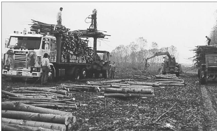
*Figura 6* – Il carico degli assortimenti di piccole dimensioni (per la produzione di carta e pannelli truciolari) richiede la presenza di un addetto posizionato sul pianale di carico che, trovandosi nel raggio d'azione della gru idraulica, è esposto a urti e rischia cadute dall'alto, dovendosi muovere su un fondo instabile e spesso sdruciolevole.
