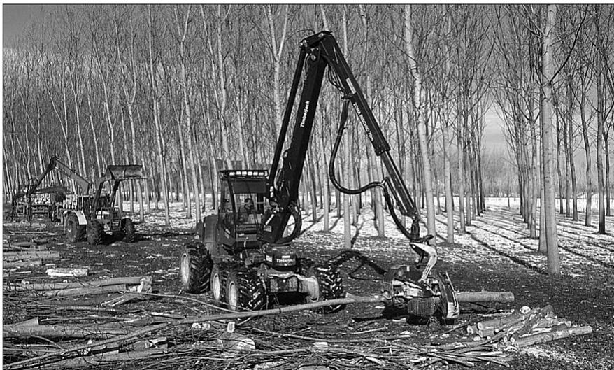
*Figura 5* – Con le testate abbatti-srama-depezzatrici è possibile allestire senza particolari difficoltà anche gli assortimenti di minori dimensioni.
