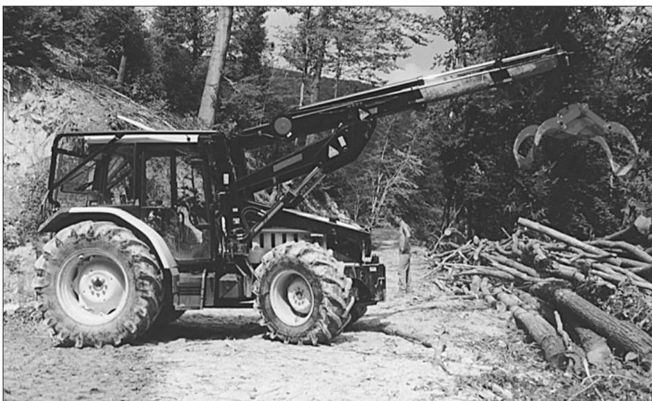
Figura 5 – Trattore agricolo equipaggiato con braccio caricatore telescopico detto «palo».
