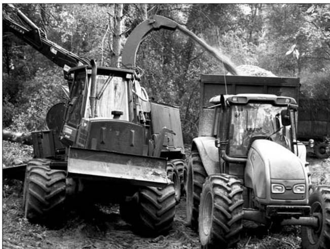
Figura 1 – Cantiere di San Piero a Grado (PI). Cippatura di pioppo e di pino domestico.
