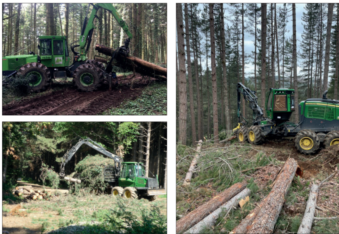
Figura 3 - Esempi di macchine forestali utilizzate per le operazioni di abbattimento ed esbosco.
